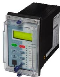
ARGUS relé de sobrecorrente Não direcional, caixa moldada tamanho 4, 4 TC, 10 LEDs, 3 entradas binárias / 3 saídas binárias. Entrada de medição: 1/5 A, 50/60 Hz de tensão auxiliar: 60 a 240 V CA / CC, limite de entrada binária 88 V CA / CC Tampa de plástico com 1 botão para teste / reinicialização Comunicação: Porta frontal: USB. Fâscia frontal: w. função de proteção dos botões de pressão de controle do disjuntor: versão padrão
